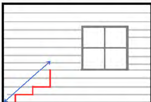
Fig. 4a Oude situatie, eerder behandelde schade (1,6 meter, 8 gebroken stenen)
