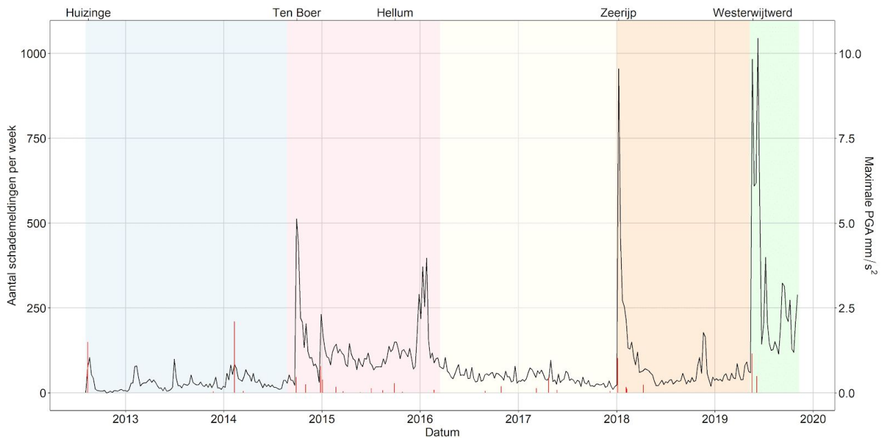
Figuur 6: Het aantal schademeldingen per week in de gemeente Groningen (zwarte lijn), met de maximale PGA's van bevingen >2,0 Richter (rode verticale lijnen) vanaf nov. 2013 met uitzondering van Huizinge (bronnen: BAG, KNMI, NAM, TCMG).
