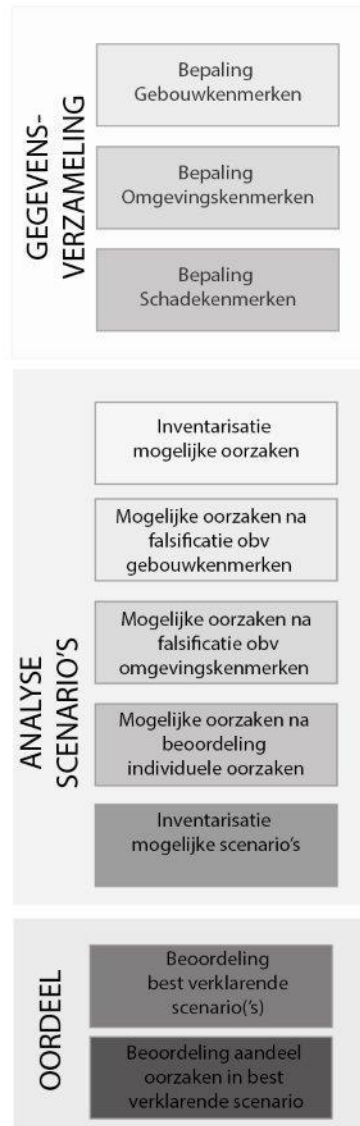
Figuur 6.1: Schematische weergave van voorgestelde methodiek schadebeoordeling (uitleg van de begrippen in paragraaf 6.3.2)
