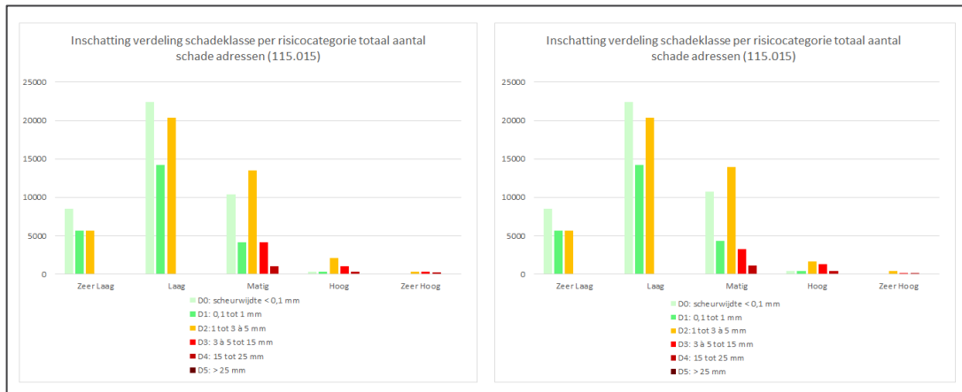
Figuur 4.6 Verdeling van de schadeklassen over de hoeveelheid adressen die per risicocategorie zijn vastgesteld met de verdeelsleutels op basis van de 87 (links, inclusief de 6 pilot-projecten) respectievelijk 81 steekproeven (rechts, exclusief de 6 pilot-projecten)
